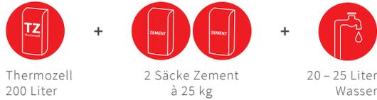
Das Anmischen unter Zugabe von Zement und Wasser erfolgt an der Baustelle. Durch unterschiedlich hohe Zementzugabe entstehen die Produkttypen pro 400, 250 und 160 mit den jeweiligen Eigenschaften.
